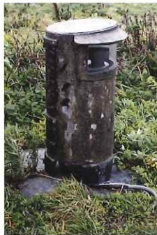
◀無人監視カメラ 衛星携帯電話システムを利用して千葉県我孫子市にある山階鳥類研究所まで鳥の様子を伝える。アホウドリを驚かさないようにケースは地味な色に塗られている
