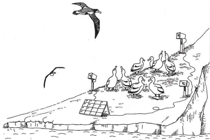
◀無人監視カメラ 衛星携帯電話システムを利用して千葉県我孫子市にある山階鳥類研究所まで鳥の様子を伝える。アホウドリを驚かさないようにケースは地味な色に塗られている
